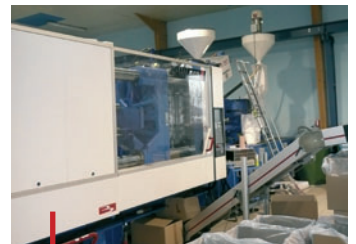
Presse Billion bi-matière 550 t pour l'essai des moules multi-empreintes à haute cadence.
