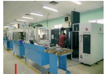
Un parc machines sans cesse renouvelé et très automatisé, notamment grâce au système de palettisation Erowa.
